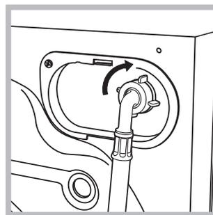
1. Ligue o tubo de alimentação na máquina de lavar roupa atarraxado no apropriado fornecimento da água, na parte traseira, em cima à direita (veja a figura).
