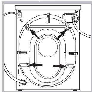
2. Scoateți cele patru șuruburi de protecție pentru transport și distanțierul respectiv, toate situate în partea posterioară (a se vedea figura).
