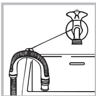
Ca alternativă, sprijiniți furtunul de golire pe marginea unei chiuvete sau a unei căzi, legând cotul din dotare la robinet (vezi figura). Extremitatea liberă a tubului de descărcare nu trebuie să rămână
