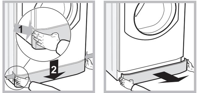
1. remova o painel de cobertura no lado anterior da máquina empurrando para o centro, em seguida empurre para baixo de ambos os lados e remova-o (veja as figuras).
