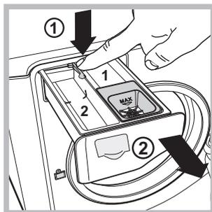
Pentru a scoate sertarul, apăsați pe levierul (1) și trageți-l spre exterior (2) (vezi figura). Spălați-l sub un jet de apă; această operație trebuie efectuată cât mai des posibil.
