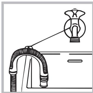
In alternativa, appoggiare il tubo di scarico al bordo di un lavandino o di una vasca, legando la guida in dotazione al rubinetto (vedi figura). L'estremità libera del tubo di scarico non deve rimanere
