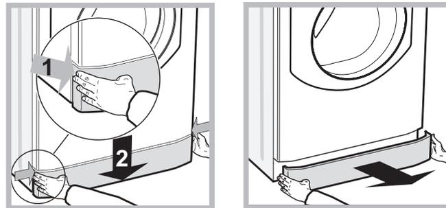
1. Îndepărtați panoul de acoperire de pe latura anterioară a mașinii, apăsând spre centru, apoi împingeți în jos de pe ambele laturi și scoateți-l (a se vedea figurile).
