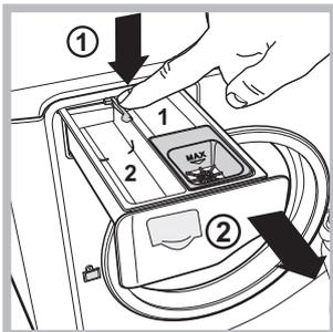
Para extrair a gaveta, pressione a lingueta (1) e puxe para fora (2) (veja a figura). Lave-a com água corrente; esta limpeza deve ser efectuada frequentemente.
