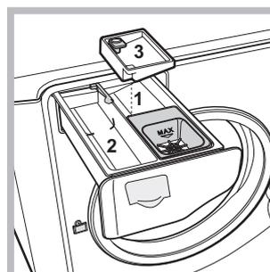
При заливке отбеливателя не превышайте "макс." уровень, указанный на стержне в центре (см. схему). Для выполнения только отбеливания без полного цикла стирки залейте отбеливатель в дополнительный дозатор 3, выберите программу «Полоскание» и включите дополнительную функцию
