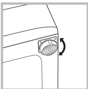
2. Compensare le irregolarità svitando o avvitando i piedini finché la macchina non sia orizzontale (non deve essere inclinata più di 2 gradi).
