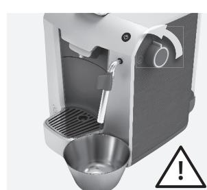
**3. Если емкость для воды пуста, машиной пользоваться нельзя! При использовании ее без воды на протяжении слишком длительного времени система автозаполнения может забыться. Для заполнения контура поместите под трубку выдачи горячей воды емкость и поверните ручку в положение выдачи пары/горячей воды. Когда из трубы пойдет стабильная струя воды, верните ручку в прежнее положение.**
