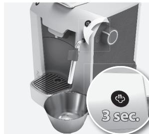
**2. Поместите под носик выдачи пара большую емкость.** Включите машину. Нажмите и удерживайте на кнопку выдачи пара в течение трех секунд, а затем поверните ручку в положение выдачи пара/горячей воды. Процесс удаления накипи займет 30 минут. При этом индикаторы выдачи пара и кофе будут попеременно мигать.
