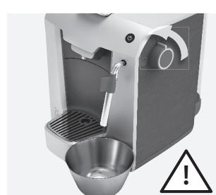
3. **Maskinen får inte användas med tom tank!** Om du använder den utan vatten under alltför lång tid kan den automatiska fyllningen blockeras. **Fyll vattenkretsen** genom att ställa en skål under pipen och vrida vredet till ång-/varmvattenläget. Vrid tillbaka vredet när flödet ur pipen är jämnt.
