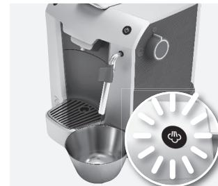
**3. По окончании удаления накипи индикатор подачи пара перейдет в режим быстрого мигания, чтобы напомнить пользователю о необходимости вернуть ручку в исходное положение. Как следует промойте емкость для воды, наполните ее свежей водой и установите на место. Поместите под носик большую емкость. Откройте ручку и промойте машину до полного опорожнения емкости для воды.**
