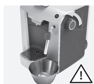
**3. La macchina non deve essere usata con il serbatoio vuoto!** Se lasciate la macchina senz'acqua per troppo tempo, l'autoinnesco potrebbe bloccarsi. **Per innescare il circuito,** posizionare un contenitore sotto la lancia vapore/acqua calda e ruotare la manopola sulla posizione acqua calda. Quando fuoriesce un getto d'acqua continuo, ruotare la manopola nella posizione iniziale.
