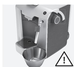
3. **Het apparaat mag niet met een leeg reservoir worden gebruikt!** Als u het te lang zonder water gebruikt, dan kan de auto-bereiding worden geblokkeerd. **Plaats om het circuit** op gang te brengen een oplangbak onder de warm-waterleiding en zet de knop in de stand stoom/heet water. Als er een stabiele stroom uit het pijpje komt, draait u de knop terug.
