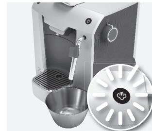
**1. Avkalkning.** Vi rekommenderar att avalkala maskinen regelbundet, beroende på vattnets hårdhet (2–3 månader). Vi rekommenderar att använda Electrolux avkalkningslösning EPD4/C/D/E/N/R (använd aldrig ättika). Ta bort och töm vattenbehållaren och fyll den med avkalkningslösning (följ tillverkarens instruktioner).
